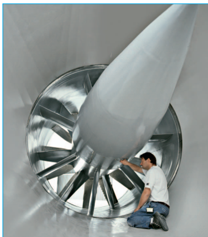
Das Flügelrad im neuen Windtunnel von LM Glasfiber hat einen Durchmesser von 3,2 m und erzeugt Windgeschwindigkeiten von bis zu 375 km/h. (Werkfoto)
